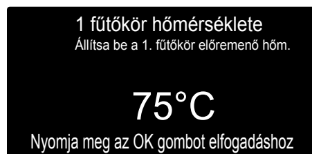
Fűtési meleg víz hőmérsékletének módosítása
